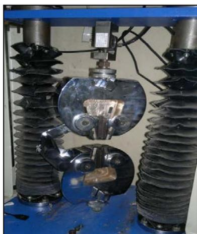
Fig. 1 a) Tensile test setup
