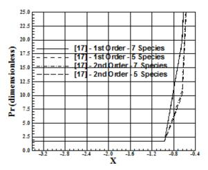
Fig. 31 Shock position (inviscid).
