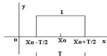
Fig. 12:  $\text{rect}_T(x - x_0)$  wave form
