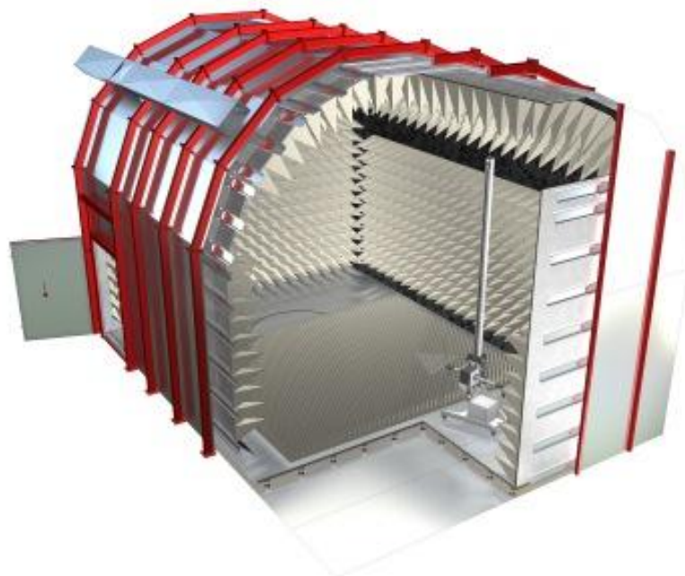
Fig. 2 Semi-anechoic chamber Frankonia SAC 3 Plus
