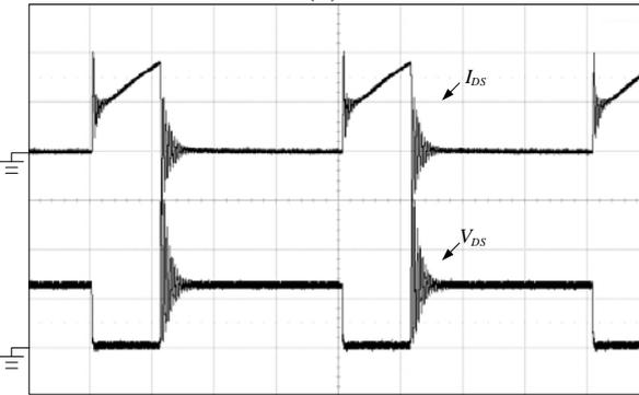
( $V_{DS}$ : 50 V/div,  $I_{DS}$ : 1 A/div, 5  $\mu$ s/div)
