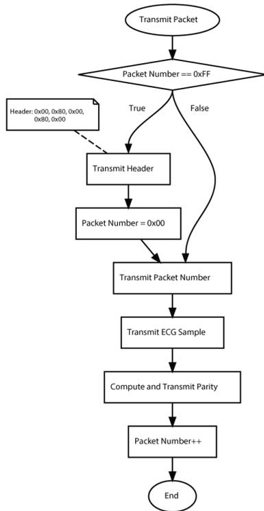
Fig. 5 – Transmit Packet routine’s flowchart
